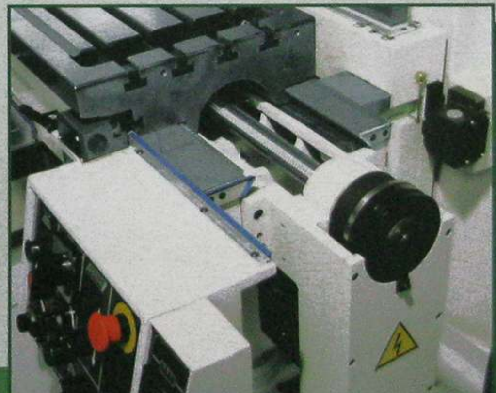
Due frizioni elettromagnetiche permettono di sganciare il cinemismo dell'avanzamento automatico durante la lavorazione in manuale tramite volantini.
