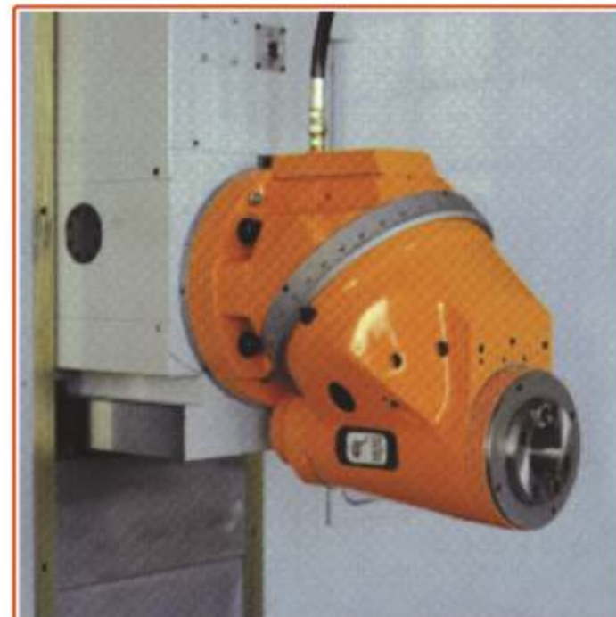
▲ TESTA AUTOMATICA A 2 POSIZIONI (verticale-orizzontale), LA PARTE POSTERIORE PUO' ESSERE ORIENTATA MANUALMENTE
