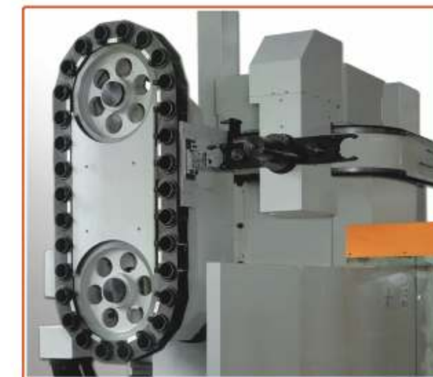
▲ CAMBIA UTENSILE AUTOMATICO A CATENA A 30, 40, 50, 60 POSTI
