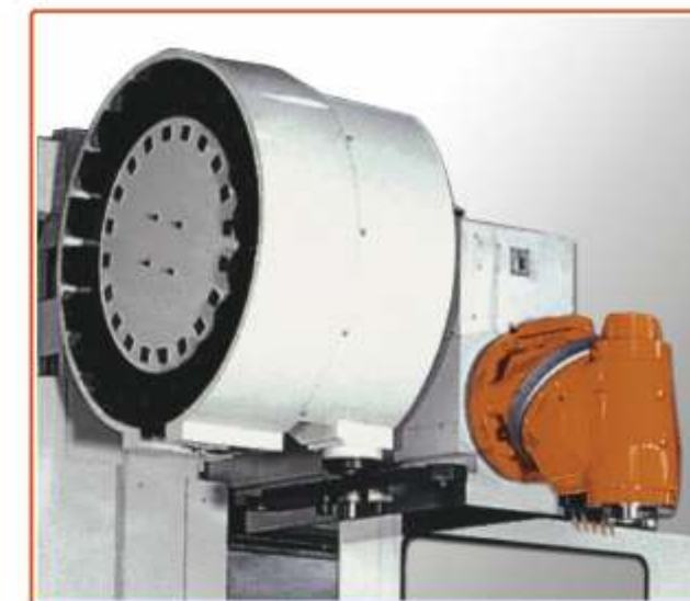
▲ CAMBIA UTENSILE AUTOMATICO A RUOTA A 12, 20, 24 POSTI
