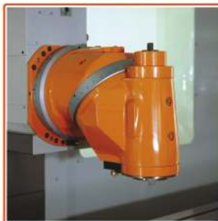
▲ TESTA AUTOMATICA INDEXATA NELLA PARTE ANTERIORE E POSTERIORE
